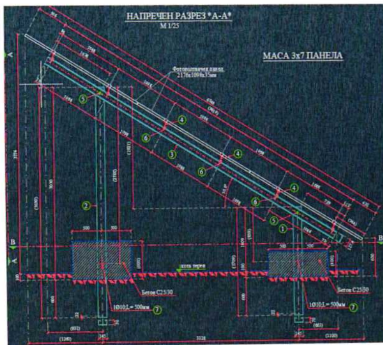
Примерна схема на конструкция чрез плитко пробиване и фундиране
